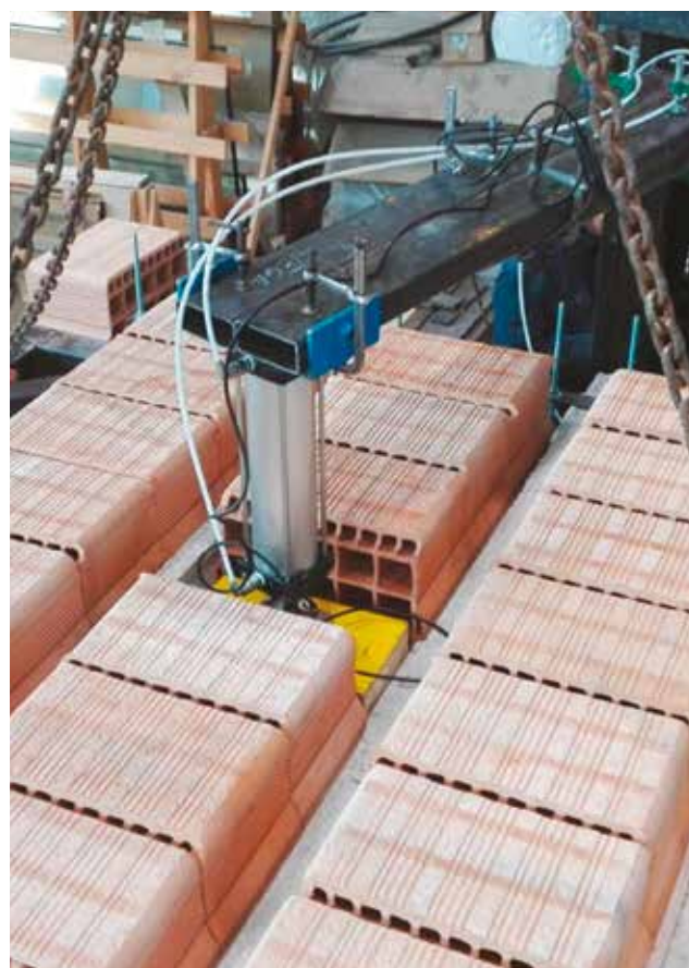
Ispitno opterećenje sustava za zaštitu s mrežom od staklenih vlakana i mortom ojačanim vlaknima.
